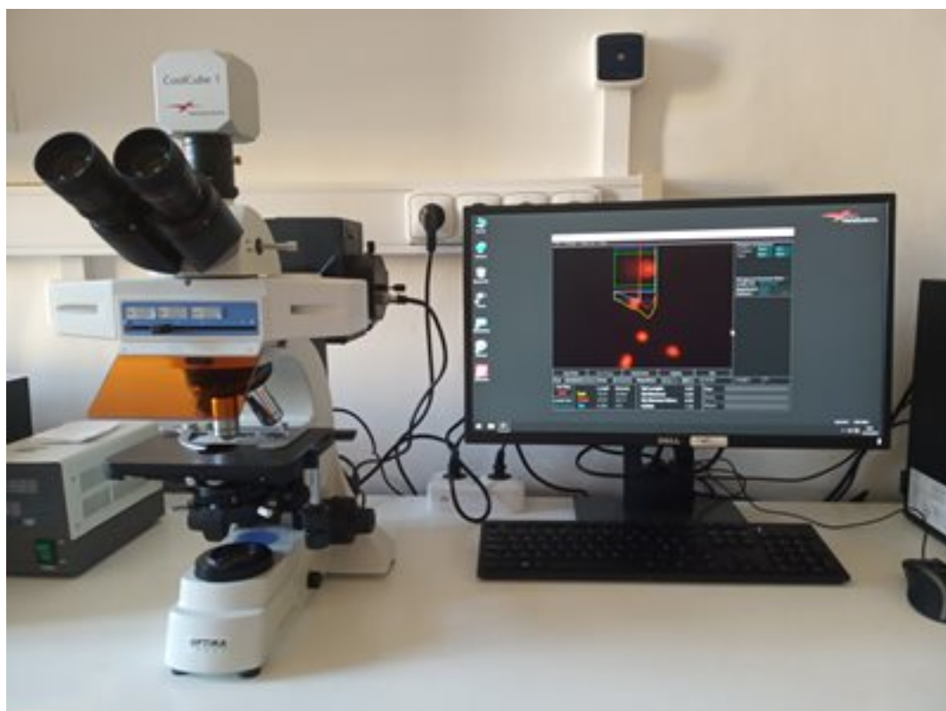
Obr. 1 (S) Sestava pro analýzu comet assay (fluorescenční mikroskop a PC se SW pro analýzu) s ukázkou měření
