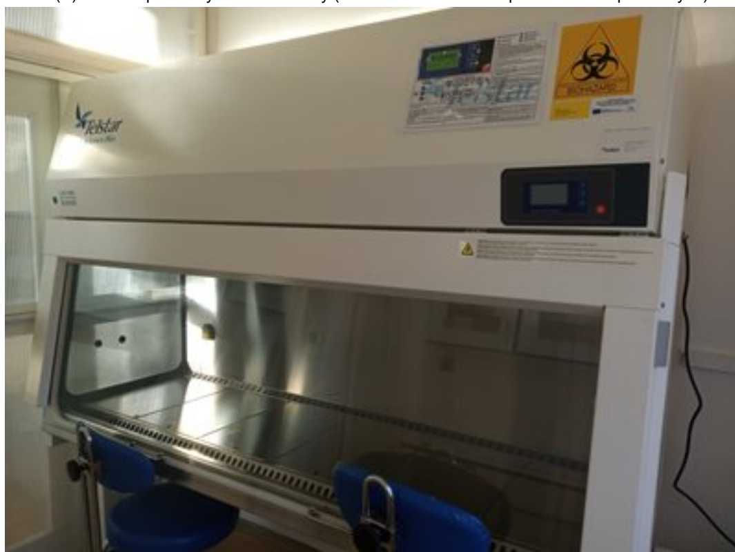
Obr. 2 Biohazard box s laminárním prouděním disponuje dvěma pracovními místy, tedy umožňuje práci dvou studentů zároveň
